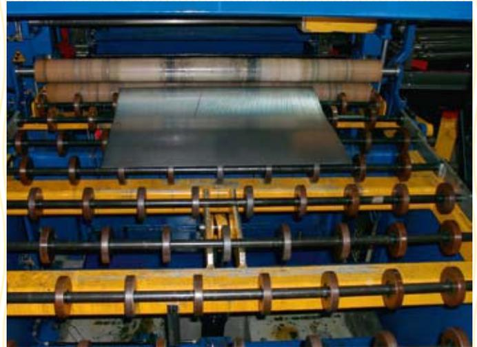
Ebenheitsmessung an dem ersten Stück eines Blech-Coils nach der Richtmaschine
